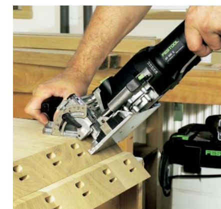
Rationell bei Gehrungen: Raststufen oder bei Zwischenwinkeln stufenlos
