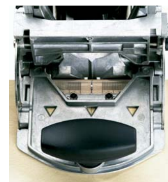
Genaueres Anlegen und sicheres Fräsen mit dem Sichtfenster
