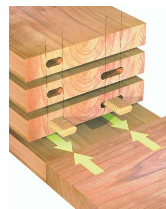
Der Dübel im Fixierloch sorgt für eine genaue Ausrichtung der Werkstücke
